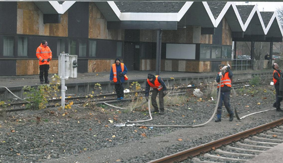
Am erwähnten Hydranten hieß es nun schnell 'Wasser Marsch', um die Lok V 200 007 mit 2 Kubikmeter Heizwasser zu versorgen. Auf der Fahrt von Lübeck bis Rinteln hatte sie bei der Beförderung des 'HEL-WESER-EXPRESS' die gleiche Wassermenge zur Beheizung der Wagen dieses Sonderzuges verbraucht.
