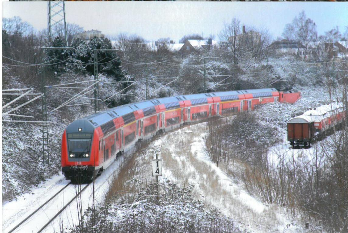
Im elektr.Fahrbetrieb wurden die RE-Züge des Eisenbahn-Schnellverkehrs Hamburg-Lübeck von Anfang an von Elektrolokomotiven d.Baureihe 112.1 befördert, was noch heute so ist. Technik und Konstruktion dieser in der ersten Hälfte d.1990er Jahre gebauten und ursprüngl.im Fern-Reisezugverkehr verwendeten Maschinen basiert auf einstiger DDR-Entwicklg.,die aus Weiterführg.der DDR-Lokbau.243 (heute 143) hervorging. Auf dem oberen Bild verläßt Lok
