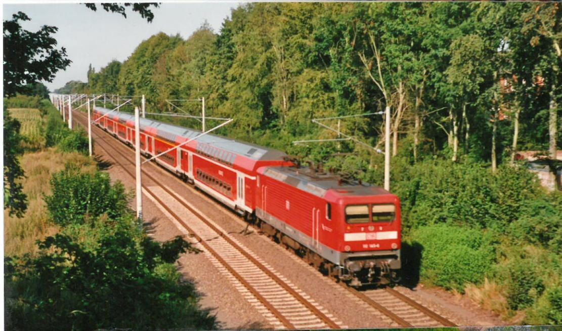
Lokomotiven fotografiert werden konnten. Auf dem mittleren Bild schiebt 112 143 im Sommer 2009 einen RE-Zug von Lübeck nach Hamburg an Lübeck-Moisling vorbei. Zum Aufnahmezeitpunkt sind die Fahrzeugeinheiten dieser Züge bereits 'umgedreht' worden: Die Wendezüge werden nun von der Lok nach Hamburg geschoben u.umgek. nach Lübeck gezogen - so wie es heute noch der Fall ist.
