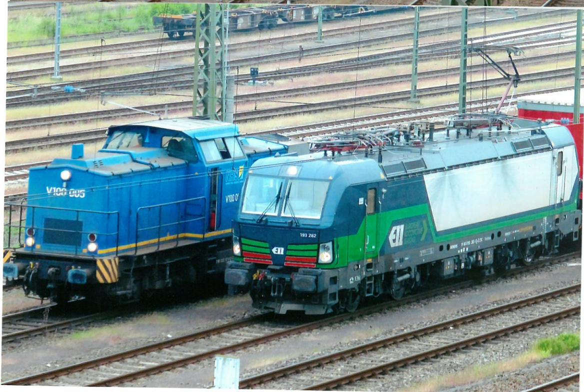
Die obigen Bilder zeigen die zum Vectron-Typ gehörende Elektrolok 193 282 der Wiener Firma 'European Locomotive Leasing' (ELL), nachdem sie am 27.5.2018 (SO) in Lübeck Hgbf mit einem KV-Zug eingetroffen ist. Diesellok V 100 005 der Lübecker Firma 'Nordic Rail Service' (NRS) steht hier schon bereit, um diesen Zug zur Weiterbeförderung über seine nur noch kurze Reststrecke von Lübeck Hgbf bis Lübeck-Siems zu übernehmen. Fotos: Rolf G. Schulz.
