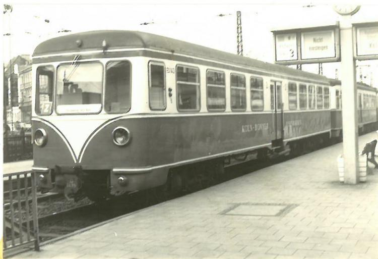
Mit diesen Trieb-/Steuerwagen-Garnituren wird nun ausschl. der verbliebene KBE-Eisenbahn-Personenverkehr auf "Vorgebirgsbahn" und "Querbahn" betrieben. Hier eine solche Einheit als Personenzug nach Köln über Brühl am 11.4.1970 im Bonner Rheinuferbahnhof. Die KBE-Strecken werden übrigens mit Gleichstrom betrieben.
