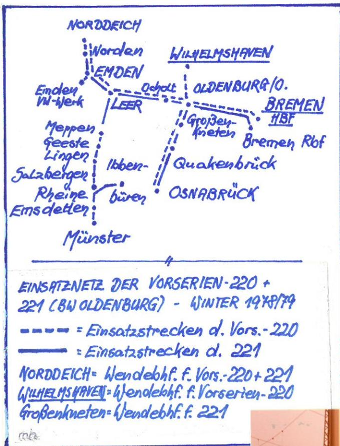
Über das planmäßige Einsatznetz der Oldenburger 221 gibt die nebenstehende Karte Auskunft. Die planmäßigen Zugleistungen dieser Maschinen sind auf den beiden nächsten Seiten einmal in Form eines Laufplan-Diagramms dargestellt. Elf Maschinen werden für diese Planeinsätze benötigt. Der große Rest von siebzehn 221 steht auch im Bw Oldenburg für Reservezwecke und Sondereinsätze bereit.
