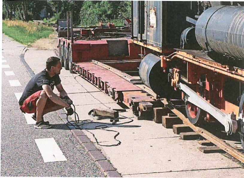
Das Verladen der Dampfspeicherlok in Geesthacht war Maßarbeit. Sie wurde per Seilwinde auf einen Spezialtieflader gezogen. Quelle: Timo Jann
