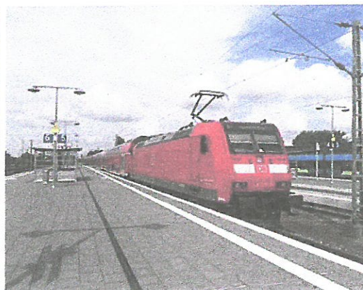
Der RE1 nach Norddeich Mole wird mit einer Lok der Baureihe 146 und sieben Doppelstockwagen erbracht
