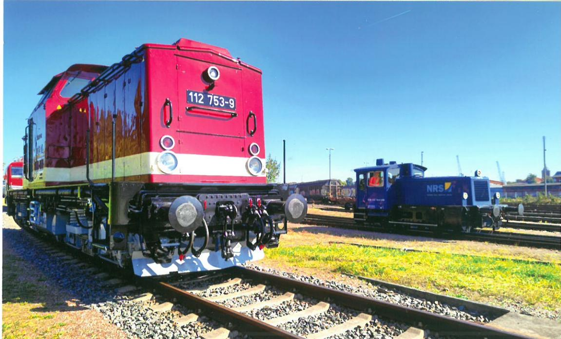
Die Diesellok 112 753 der Eisenbahn Bau- und Betriebsgesellschaft Pressnitztalbahn mbH (kurz PRESS GmbH oder PRESS) wurde 1975 vom LEW-Werk in Hennigsdorf in der DDR fabrikneu für die Deutsche Reichsbahn gebaut, die sie zunächst unter der Betr. Nr. 110 753 einsetzte. 1988 erhielt sie einen stärkeren Motor und fuhr nun als 112 753, ab 1992 als 202 753. Unter dieser Nr. gelangte die beschriebene und auf den neben stehenden Bildern beim Tag d. Schiene in Lübeck am 21.9.2024 abgebildete Masch.
