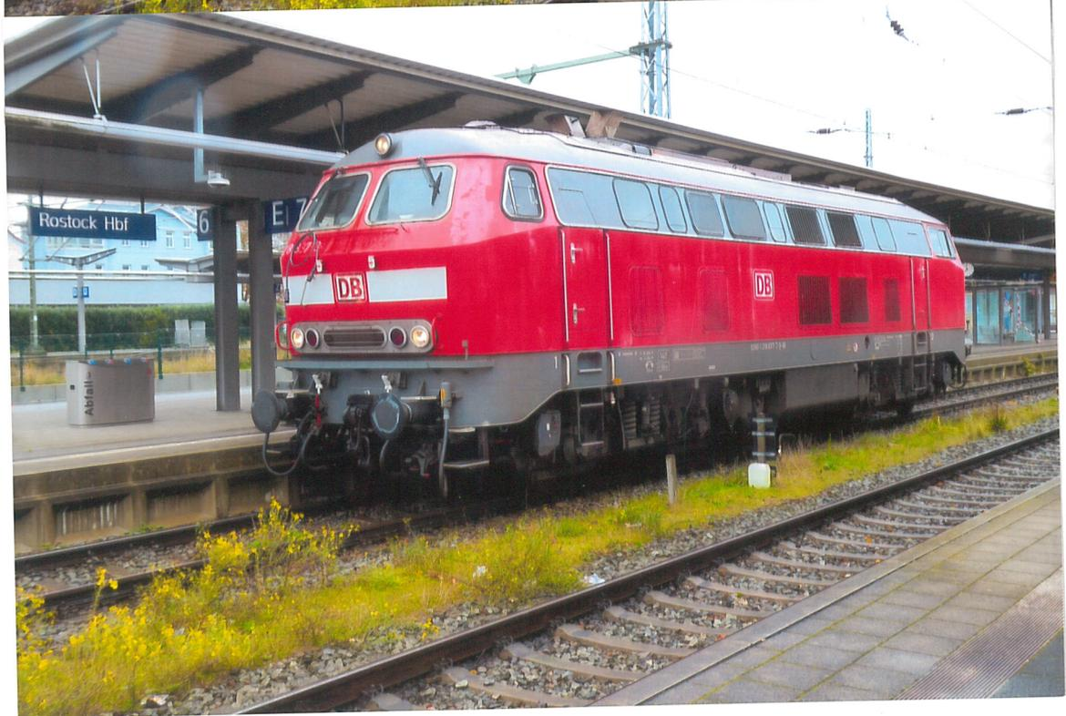
Gleich hinter der Diesellok 218 837 lief im IC 2260 (Hamburg-Rostock) am 27.10.2025 (MO) die 101-Ellok, die diesen Zug von Hamburg nach Lübeck befördern hatte und ab Lübeck antriebslos als Wagen im o.a. Umleiter-IC mitfuhr. Im Rostocker Hbf wurde wieder ihr Bügel an den Fahrdrabt gelegt, weil sie die Wagen vom IC 2260 in die Abstellanlage dieses Hbf's schieben sollte, was auch so geschah. 218 837 folgte dieser Rangierfahrt alleine zur Kurz-Abstellung ins Hbf-Vorfeld.
